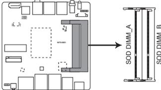
**NITX-BD1 204-pin DDR3L DIMM sockets**
